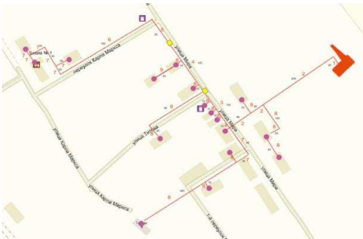
Рисунок 1.3.2.1 – Схема тепловых сетей котельной №1 МУП ЖКХ «Надежда».
