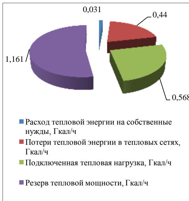
Рисунок 1.6.4 – Баланс тепловой мощности котельной №5 МУП ЖКХ «Надежда», Гкал/ч
