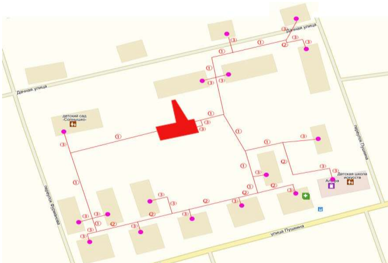
Рисунок 1.3.3.1 – Схема тепловых сетей котельной №2 МУП ЖКХ «Надежа».
