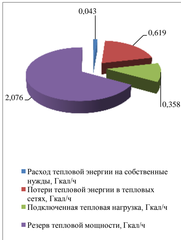
Рисунок 1.6.2 – Баланс тепловой мощности котельной №1 МУП ЖКХ «Надежда», Гкал/ч
