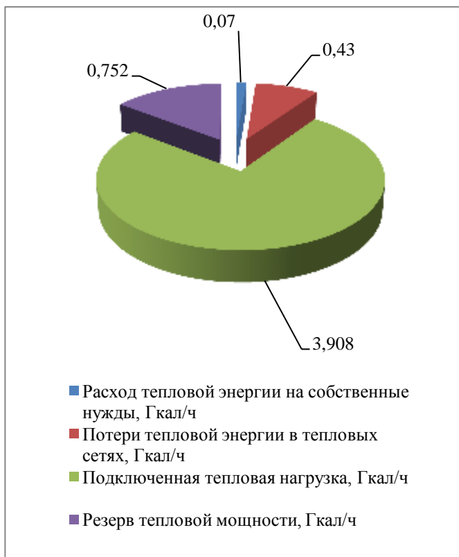
Рисунок 1.6.1 – Баланс тепловой мощности котельной ООО «Гортепло» Гкал/ч
