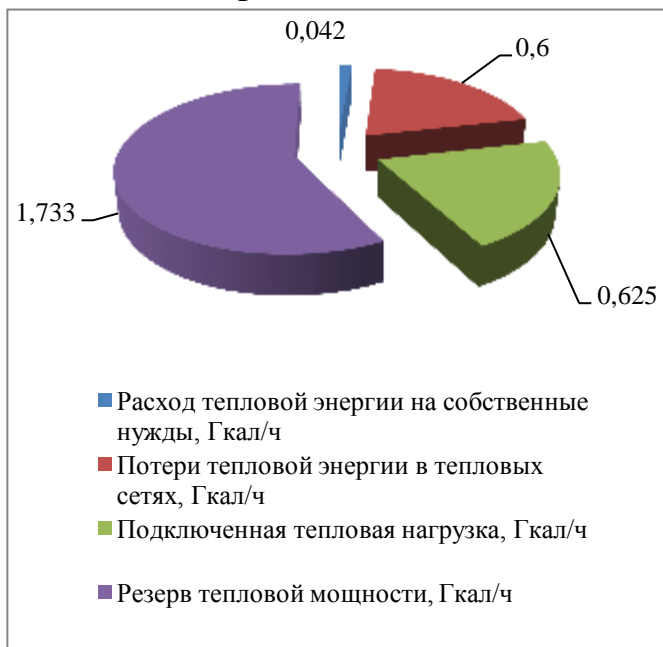
Рисунок 1.6.3 – Баланс тепловой мощности котельной №2 МУП ЖКХ «Надежда», Гкал/ч
